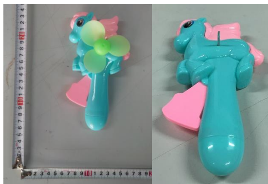
跌落测试后，风扇脱落，形成危险突出物
