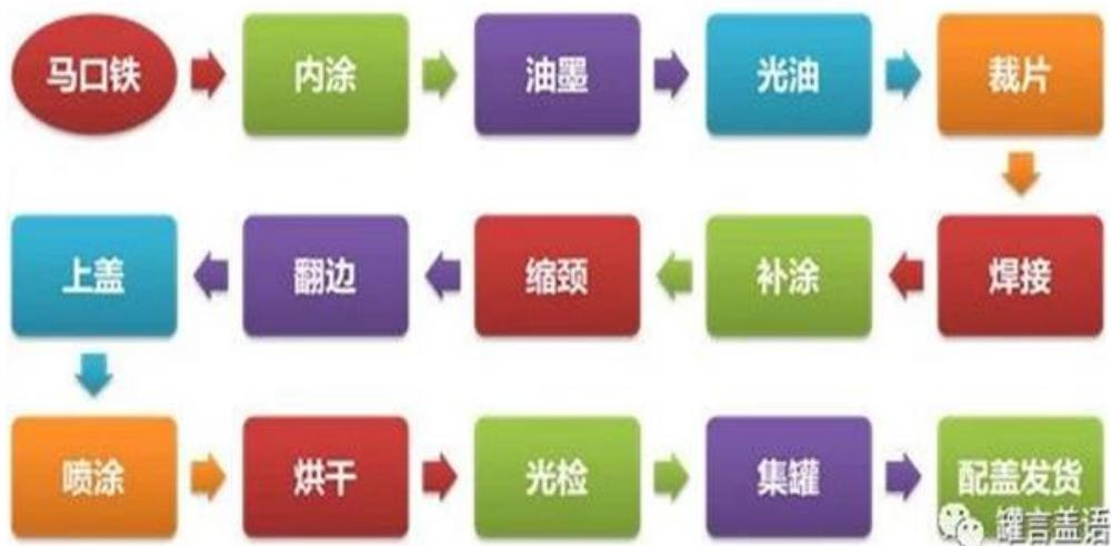
图 1 金属三片罐生产工艺流程
